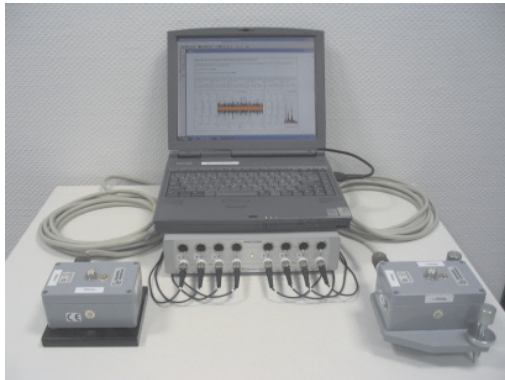
Schwingungsmesser nach DIN 45669-1
