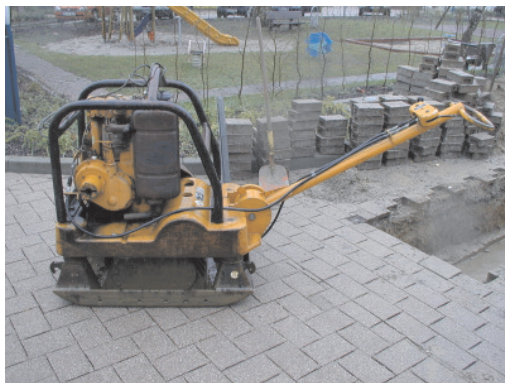
Anregung aus Baubetrieb: Rüttelplatte
